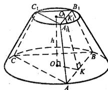
Боковые грани — равные равнобедренные трапеции. Построим  $OK_1 \perp A_1B_1$ ,  $OK \perp AB$ , отрезок  $K_1K$ . По теореме о трех перпендикулярах  $K_1K \perp AB$ .
